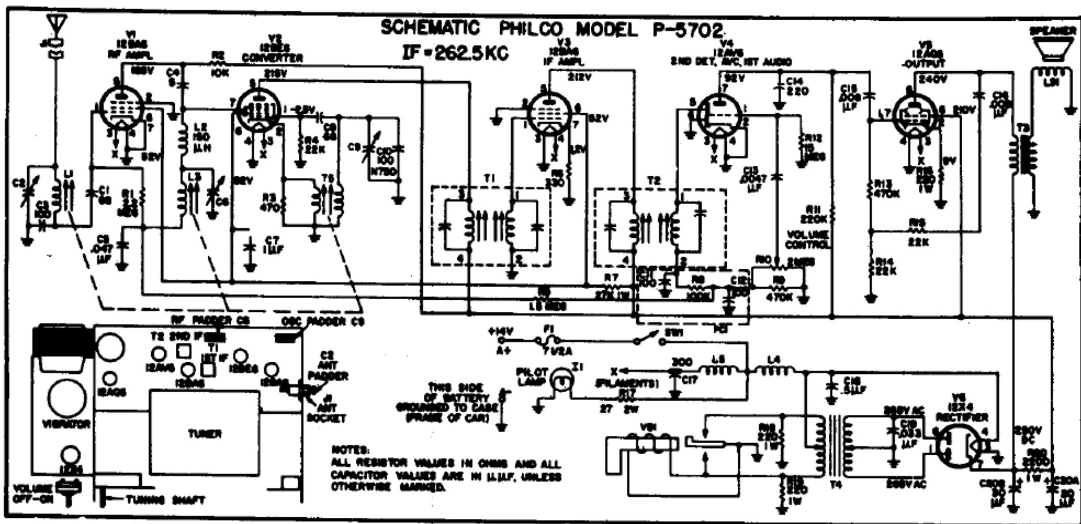
**PHILCO CORPORATION - Mod. P 5702. Apparecchio autoradio di produzione americana. È provvisto di una amplificatrice in alta frequenza. Le valvole sono di tipo normale, ad elevata tensione anodica. Media frequenza a 262,5 kc/s. Consumo 50 watt. Resa d'uscita 2 watt.**
